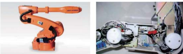
应用于机械人配线的要求，应注意线材的耐弯数、来回扭曲数等。可选特柔型、极柔型、耐磨型产品。
